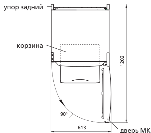
Рисунок 2 — Холодильник (вид сверху)
