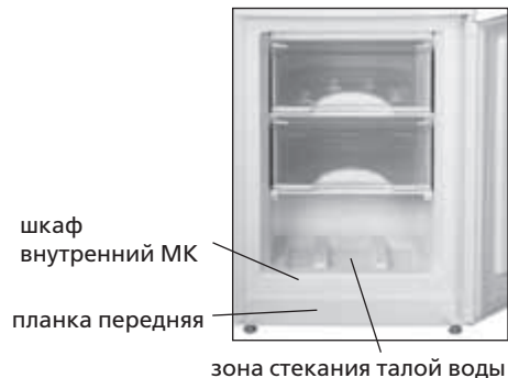
Рисунок 6 – Сбор талой воды из МК
